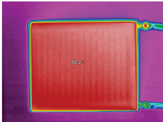
obr.č.12 Plechové otopné těleso konec měření 4 min
